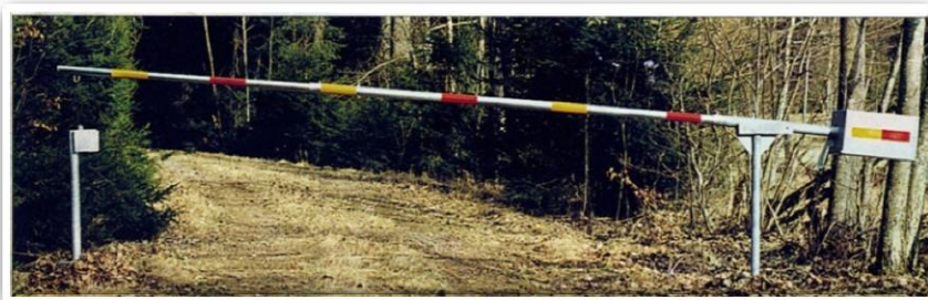
Lyftbom med motviktsbehållare fylld med grus till jämnviktsläge.
