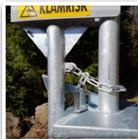
Lyftbom, låst med kätting och hänglås i öppet läge.
